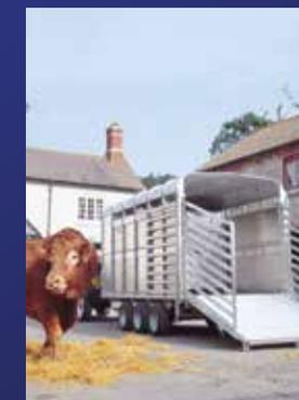
I trailer sono disponibili con lunghezza 3,11 m, 3,72 m e 4,34 m e con una altezza di testa standard di 1,82 m. I triasse sono opzionali per i modelli 3,72 m e standard per i modelli di lunghezza 4,34 m.
