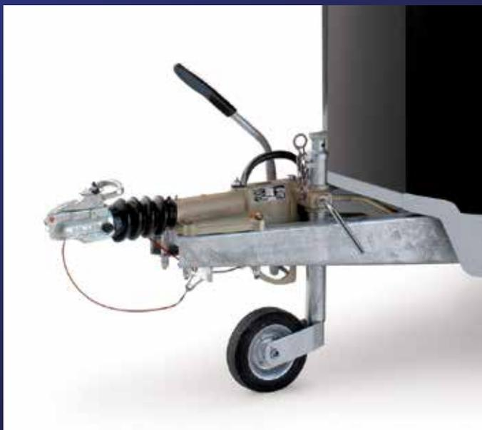
Una testa di accoppiamento in ghisa fa parte della dotazione standard per i modelli di trailer per due cavalli, il che offre una elevata stabilità e particolare robustezza - per la vostra sicurezza e quella del vostro cavallo.
